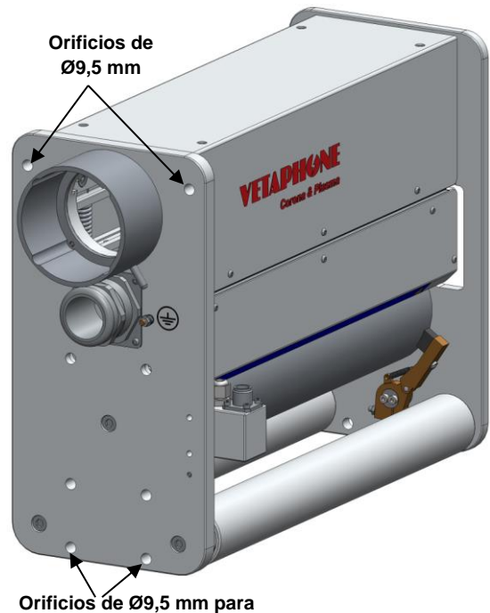
Figura 4.2.1b: Orificios de montaje para orificios en voladizo
